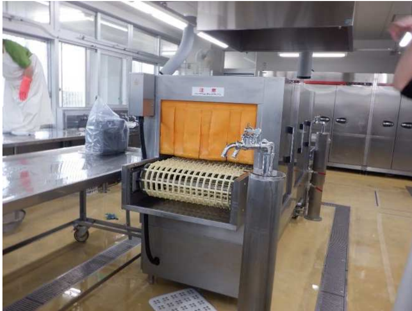
洗浄機の全長が2350mm。水栓柱及び天井扇との位置関係に配慮が必要。
