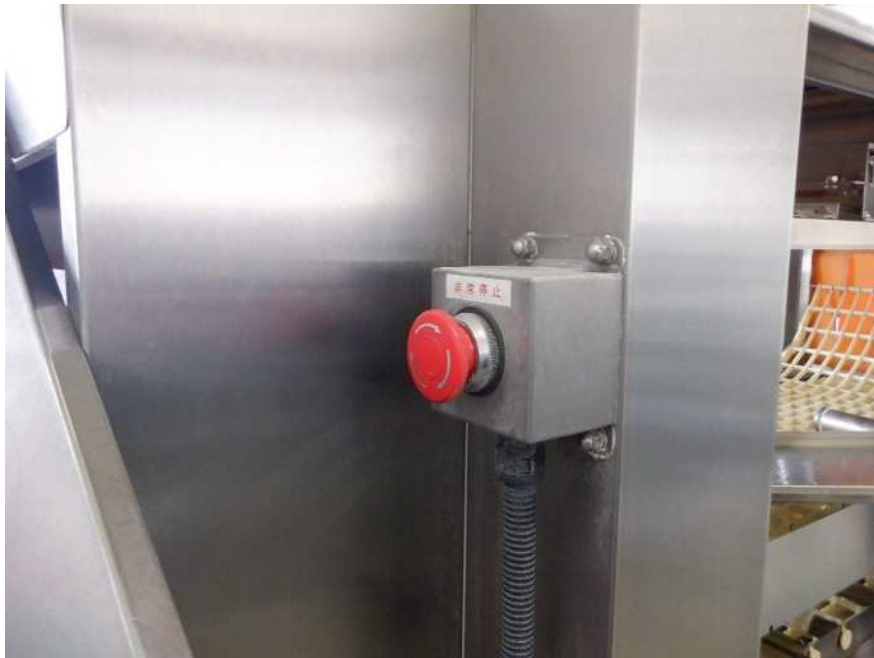
↑ 出口側に緊急停止ボタンあり
